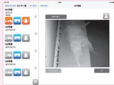
居室から離れていてもシルエット画像による状況の確認が可能です。居室に入居する必要がなく、介護する方/介護される方 双方の負担を軽減します。また、履歴の保存により、従来のセンサでは難しかった「何が起こったのか?」の把握を実現し、介護する方の多忙なお仕事をサポートします。
